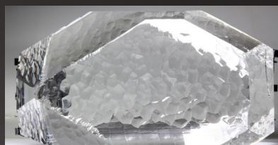
Synthetischer Quarz gezüchtet aus einer wässrigen Lösung bei 400 °C und 0,2 Gigapascal (2000 Atmosphären) Druck. Die jährliche Weltproduktion an Piezo-Quarz beträgt ca. 10 000 Tonnen.
