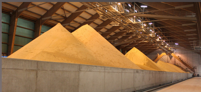
Gipsdepot des Braunkohlkraftwerks Schwarze Pumpe (Brandenburg) im Juni 2013. Der bei der Rauchgasentschwefelung als Abfallprodukt anfallende Gips wird von einem benachbarten Betrieb zu Gipskartonplatten verarbeitet. Quelle: wikimedia commons, Foto: Didier Descouens
