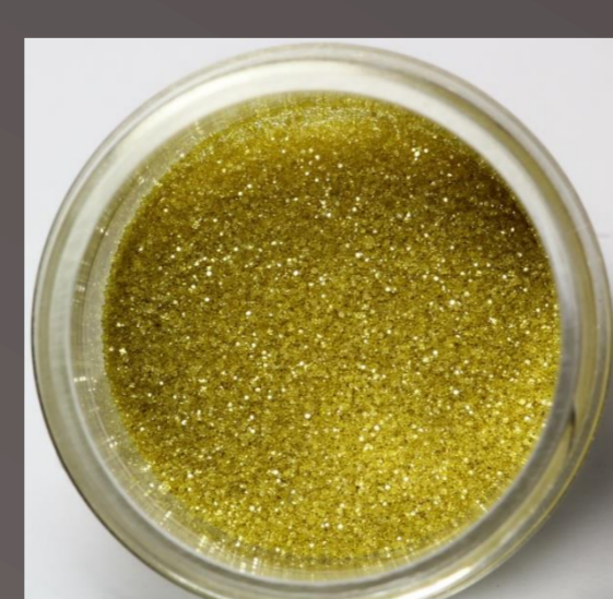
Industriediamant (ca. 0.1 mm) aus der Produktion der Fa. Winter, Norderstedt
