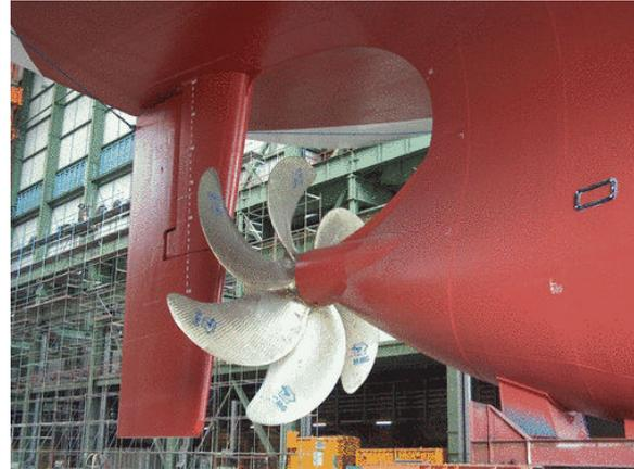
**Abbildung 1:** Skew Propeller.
