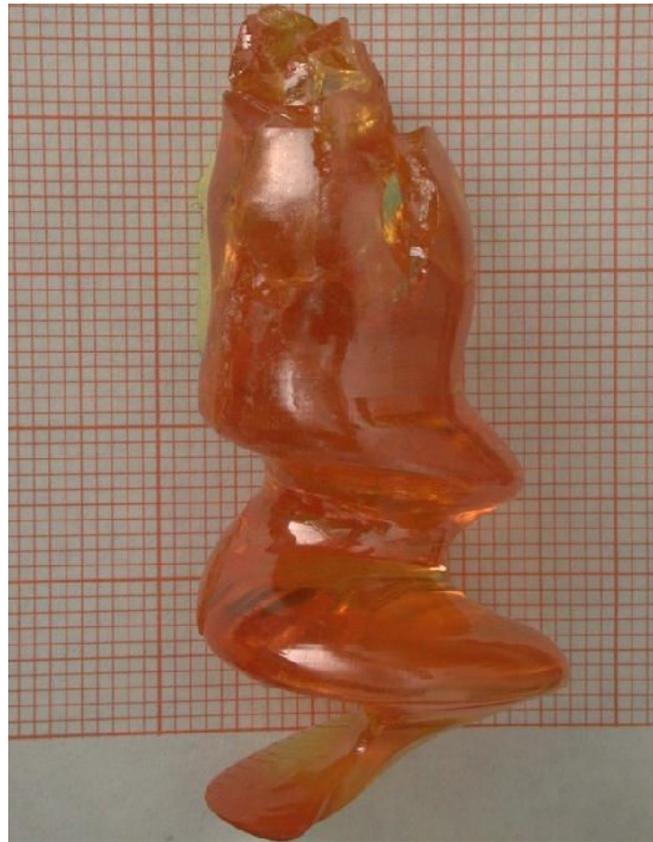
**Abbildung 1:** Spiralwachstum bei oxidischen Kristallen im Czochralski-Prozess, links Dysprosiumscandat ( $\text{DyScO}_3$ ), rechts Samariumscandat ( $\text{SmScO}_3$ )
