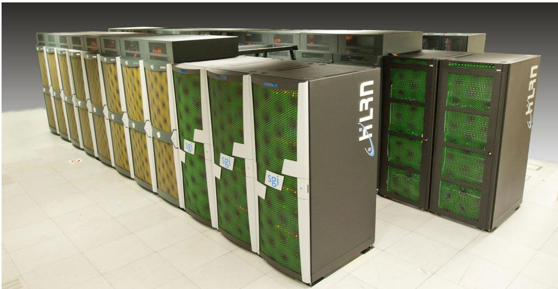
**Abbildung 3:** Das HLRN-II-System ist an jedem Standort in 49 Racks untergebracht, davon 28 für Computersysteme, 13 für Plattensysteme, 6 für InfiniBand-Switches und 2 für weitere Server.
