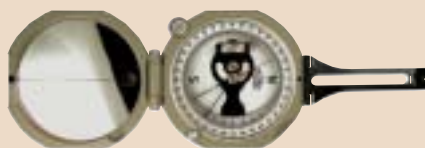
Universal Geologenkompaß Nr. 370 COBRU Universeller Geologenkompaß mit Libellen- Neigungsmesser und umfangreichem Zubehör
