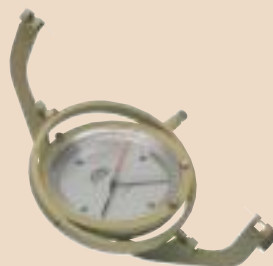
Grubenkompaß Nr. 339 COMTA Kompaß im Kasseler Gehänge (kardanische Aufhängung) für markscheiderische Arbeiten
