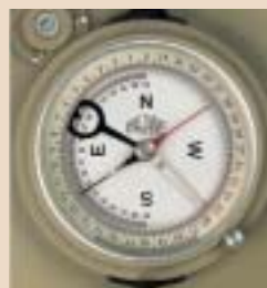
Geologenkompaß mit Neigungsmesser Nr. 329 CONEF Robuster, präziser Geologenkompaß mit stabiler Grundplatte
