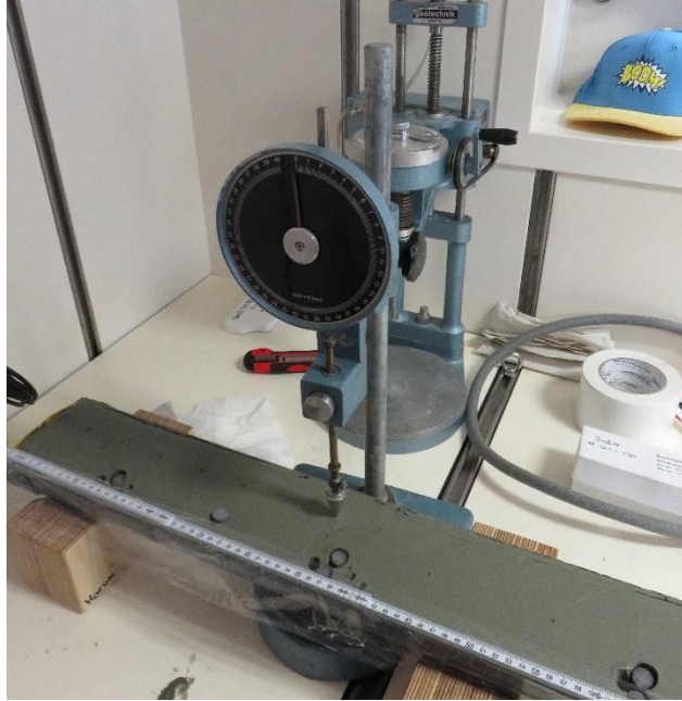
Fig. 5.11.1: Falling cone penetrometer WF 21600
