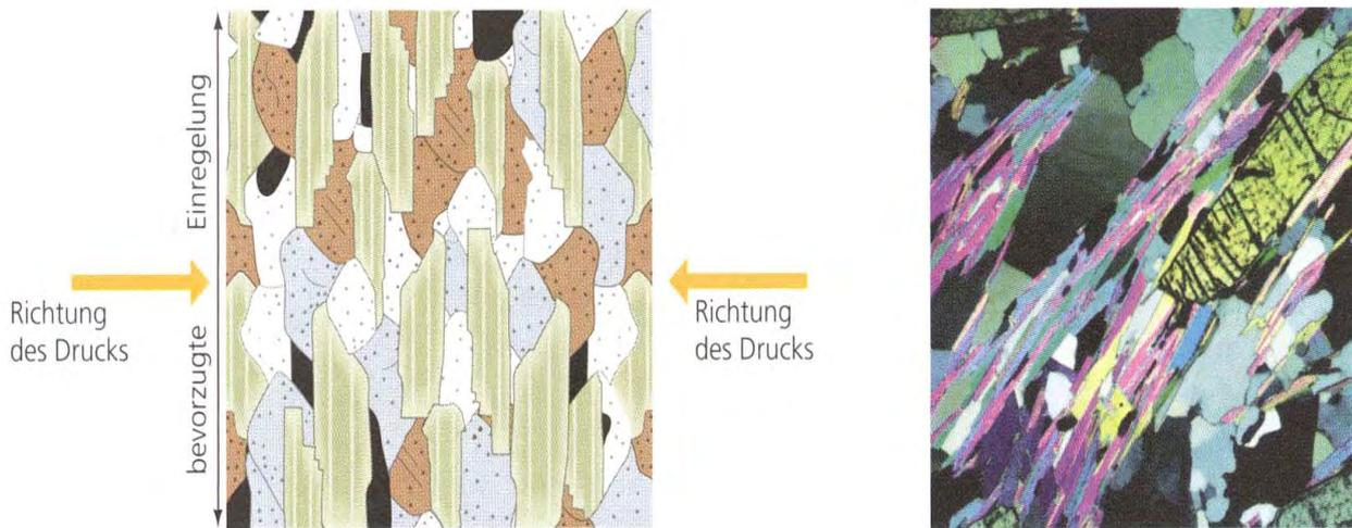
Abb. 4.4. Einregelung von blättchen- und stäbchenförmigen Mineralen (> Paralleltexur) aufgrund eines gerichteten Druckes, z.B. im Zuge einer Gebirgsbildung. Links: schematische Darstellung; rechts: Dünnschliffbild (aus Press und Siever, 2004).
